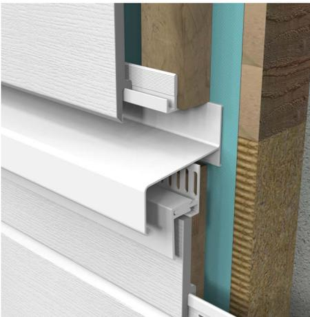
Si se tiene una fachada de más de 6m de altura se deberá prever un descanso horizontal para facilitar la ventilación por encima y por debajo del descanso con un perfil goterón Aluminio. (FCA3063)
