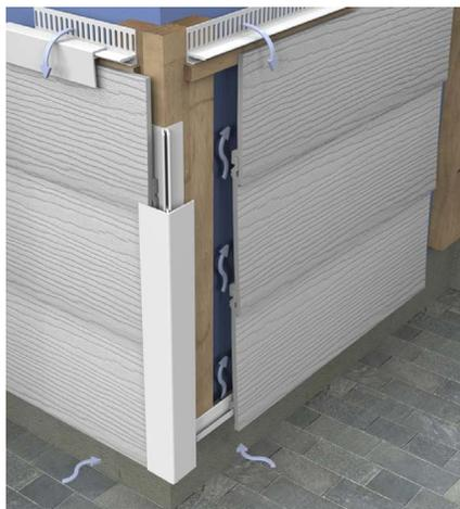
LA CÁMARA DE AIRE DEBE ESTAR IMPERATIVAMENTE VENTILADA MEDIANTE LAS REJILLAS ADECUADAS
